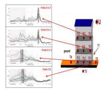
Gambar 5. Frekuensi gedung dan tanah dasar gedung bagian Utara
