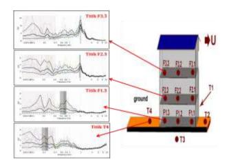
Gambar 7. Frekuensi gedung dan tanah dasar gedung bagian Selatan
